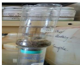
Gambar 12. Penyaringan Air hasil Flokulasi dengan Pasir Silika GB 2
