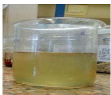
Gambar 13. Air hasil penyaringan dengan Pasir Silika GB 2 Tahap adsorpsi dengan menggunakan Karbon Aktif
