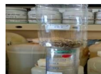
Gambar 10. Penyaringan Air hasil Flokulasi dengan Pasir Silika GB 1
