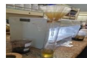
Gambar 9. Penyaringan Air hasil Flokulasi dengan Kertas Saring untuk di lewatkan pada pasir Silika GB 1
